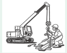
「玉掛けの業務」とは、つり具(ワイヤーロープ、チェーン等)を用いて行う、荷かけ及び荷はずしの業務です。 全登協「玉掛け教本」より
