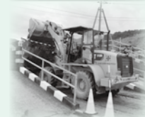
ダンピング作業中のトラックターショベル(タイヤ式)
